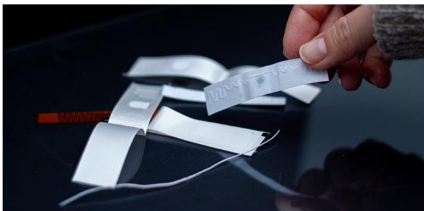
Figur 36. RFID taggar testas som informationsbärare för textil.
