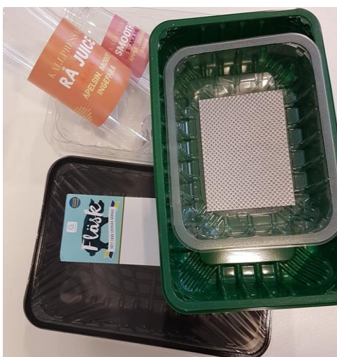
Figur 15 Kötttråg med film, etiketter och absorptionskudde som depolymeriserats
