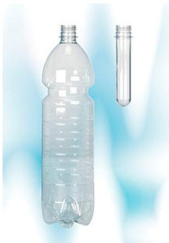
Figur 11 Formsprutat ämne för formblåsning samt färdigformad flaska.
