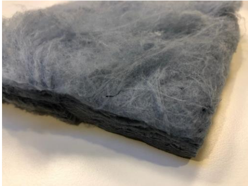
Fig 28. Återvunnen textil som smälts om och använts till nonwoven.
