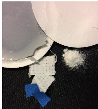
Fig 35. Avfärgat och depolymeriserat prov av sjukhustextil.
