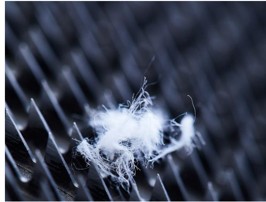
Figur 25. Sågtänder i textilriven på RISE
